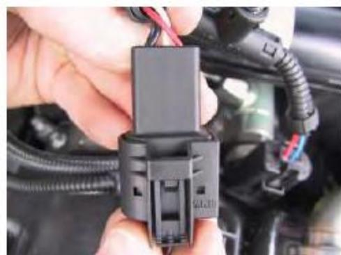
*Штекеры имеют различную форму, в зависимости от модели автомобиля*
